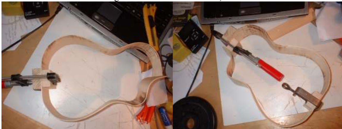
4. Zusammenleimen der Zargen. Vorne einen Block hin, und Hinten auch.
